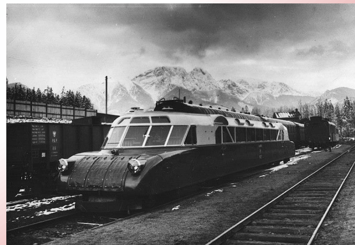
TORPEDA PODHALAŃSKA" (LUXTORPEDA, PRĘDKOŚĆ MAKSYMALNA: 115 KM/H) NA DWORCU KOLEJOWYM W ZAKOPANEM W POLSCE W 1936 R. W TLE GIEWONT.
